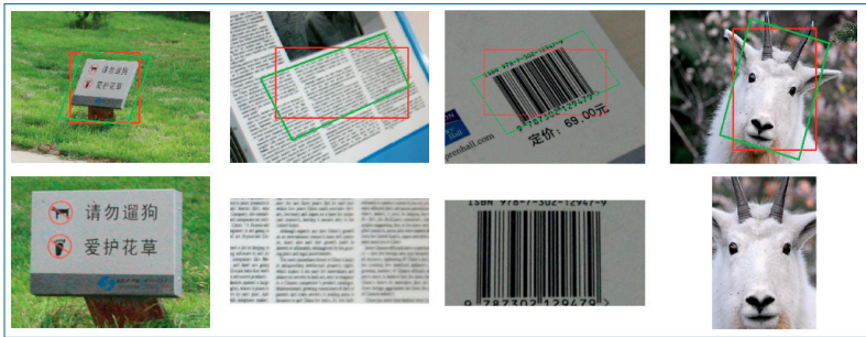
图4 利用TILT模型进行图像校正的例子(第一行表示原始的图像块(长方形框)及相应校正变换(四边形框,校正变换就是四边形框相对于长方形框的几何变换),第二行是校正后的图像块)
